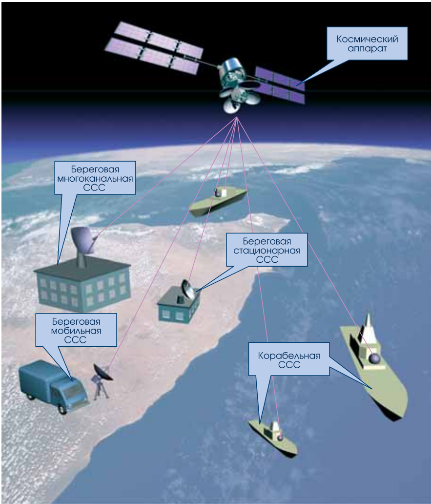
Рис. 1. Схема организации связи через космический аппарат с использованием семейства станций спутниковой связи типа "Центавр-НМ"
